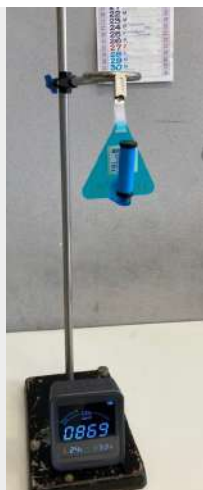
FIGURA 3. POSTAZIONE PER IL CAMPIONAMENTO DEL BISSOIDO DI AZOTO E IL MONITORAGGIO IN CONTINUO DELLA ANIDRIDE CARBONICA, NELL'AULA DELL'ISTITUTO NAUTICO C. COLOMBO DI CAMOGLI.
