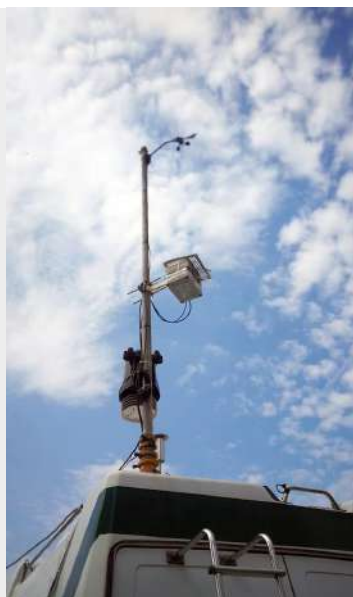
FIGURA 2. LA CENTRALINE LC403, SOPRA LA LC305, ENTRAMBE SUL TETTO DELLA STAZIONE MOBILE ARPAL 1, POSIZIONATA IN LUNGOMARE CANEPA (GE). IL CONFRONTO DELLE MISURE GIORNALIERE DI PM_{10} E PM_{2,5} , EFFETTUATE DALLE DUE CENTRALINE LC, È AVVENUTO DAL 16/7/2020 AL 30/9/2020.
