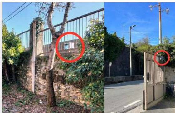
FIGURA 2. LOCALIZZAZIONE DEI CAMPIONATORI PASSIVI, INSERITI NEL BOX DI PROTEZIONE DALLA PIOGGIA (CERCHIO ROSSO): SULLA CANCELLATA DELL'ISTITUTO COMPRENSIVO BORZOLI, LATO RIVOLTO VERSO IL DEPOSITO PETROLCHIMICO, E SUL CANCELLO DI UNA AUTOFFICINA, LUNGO VIA BORZOLI.
