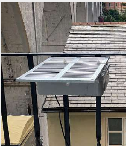
FIGURA 7. CENTRALINA LC, ESPOSTA SU UN BALCONE, CON COPERTURA ALETTATA IN ALLUMINIO PER DISPERDERE IL CALORE E PROTEGGERE DALLA PIOGGIA LA "PRESA" D'ARIA.
