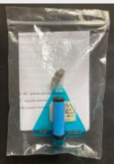
FIGURA 4. PREPARAZIONE, NELLA SALA PROFESSORI DEL NAUTICO DI CAMOGLI, DEI CAMPIONATORI DA CONSEGNARE ALLE "SENTINELLE" PRIMA DELLA LORO USCITA DA SCUOLA. CAMPIONATORE PASSIVO INSERITO IN BUSTA DI POLIETILENE A CHIUSURA ERMETICA, INSIEME A COPIA DEL QUESTIONARIO, PRONTO PER LA CONSEGNA ALLA "SENTINELLA" INCARICATA DI ESPORLO NELLA SUA ABITAZIONE.
