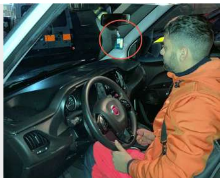
FIGURA 3. IL CAMPIONATORE PASSIVO (CERCHIO ROSSO) ALL'INTERNO DELL'ABITACOLO DI UNA DELLE AMBULANZE CHE HANNO PARTECIPATO AL CAMPIONAMENTO DI BTEX
