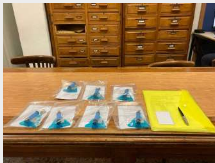
FIGURA 3. POSTAZIONE PER IL CAMPIONAMENTO DEL BISSOIDO DI AZOTO E IL MONITORAGGIO IN CONTINUO DELLA ANIDRIDE CARBONICA, NELL'AULA DELL'ISTITUTO NAUTICO C. COLOMBO DI CAMOGLI.
