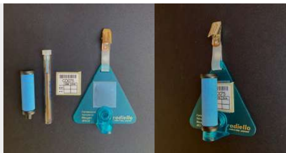
FIGURA 1. COMPONENTI DEL CAMPIONATORE RADIELLO (CORPO DIFFUSIVO, CARTUCCIA ASSORBENTE, ETICHETTA CON CODICE IDENTIFICATIVO, SUPPORTO) E CAMPIONATORE ASSEMBLATO, PRONTO ALL'USO.
