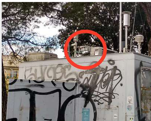
FIGURA 2. LA CENTRALINE LC403, SOPRA LA LC305, ENTRAMBE SUL TETTO DELLA STAZIONE MOBILE ARPAL 1, POSIZIONATA IN LUNGOMARE CANEPA (GE). IL CONFRONTO DELLE MISURE GIORNALIERE DI PM_{10} E PM_{2,5} , EFFETTUATE DALLE DUE CENTRALINE LC, È AVVENUTO DAL 16/7/2020 AL 30/9/2020.
