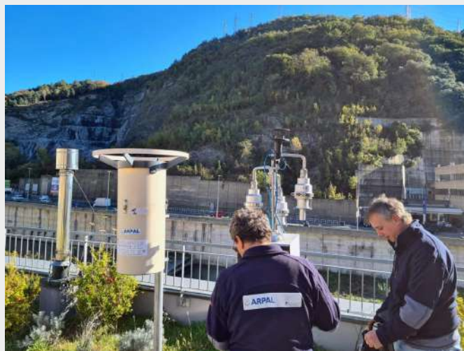
FIGURA 3. STAZIONE MOBILE, COLLOCATA IN VAL BISAGNO (MOLASSANA), PER CONTROLLARE LE EMISSIONI PRODOTTE DALLA PRODUZIONE DI ASFALTO NELLA CAVA CAVALLETTI, POSTA DI FRONTE, SULLA SPONDA OPPOSTA DEL BISAGNO. I TECNICI ARPAL STANNO MONTANDO UN CAMPIONATORE DI POLVERI "SELETTIVO", OSSIA CHE SUDDIVIDE LE POLVERI A SECONDA DELLA DIREZIONE DI PROVENIENZA DEL VENTO. A FIANCO UN "DEPOSIMETRO" PER LA RACCOLTA DELLE "DEPOSIZIONI" OSSIA TUTTO CIÒ CHE CADE DAL CIELO, COMPRESA LA PIOGGIA. STRUMENTO UTILE PER VALUTARE LA FRAZIONE PIÙ GROSSOLANA, ALTRIMENTI SCARTATA NELLA MISURA DEL PM 10 .
