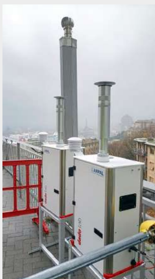
FIGURA 5. CAMPIONATORI SEQUENZIALI, CONFORMI ALLA NORMA EN12341:2014 ED EN16909:2017 PER LA DETERMINAZIONE DEL PM 10 , CON ANALIZZATORE DI RESIDUI CARBONIOSI (BLACK CARBON), IN TEMPO REALE, DIRETTAMENTE SUL FILTRO IN CAMPIONAMENTO. GRAZIE ALL'INTEGRAZIONE DELLA TECNOLOGIA OTTICA, QUESTO STRUMENTO PERMETTE LETTURE, IN TEMPO REALE, DEI VALORI DI "BLACK CARBON" PRESENTI NEL PARTICOLATO.
